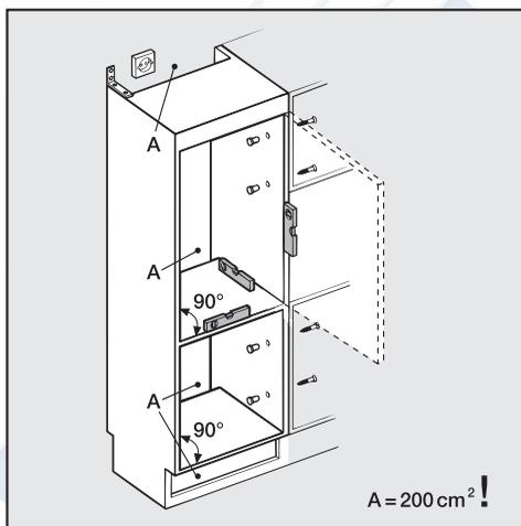
Перед встраиванием прибора следует выполнить тщательное выравнивание мебельного шкафа с помощью ватерпаса. Все углы шкафа должны составлять 90°. Отрегулируйте двер-
